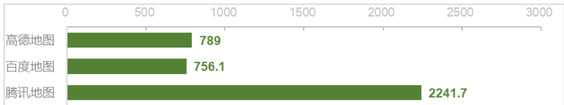
图 2 通过语音交互方式完成一次地图导航活动的平均上传数据流量 (单位: KB)
